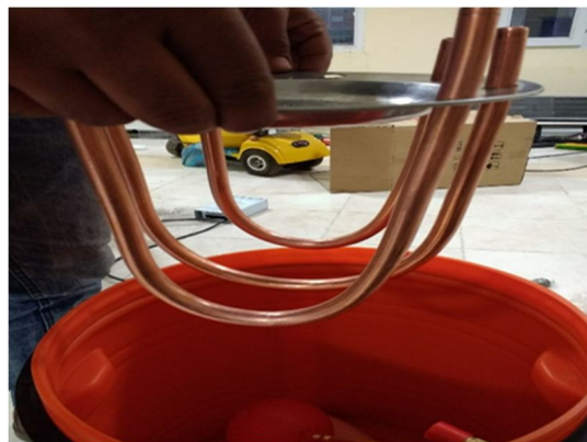
شکل ۳- قرار دادن ماده pcm در منبع انبساط.
