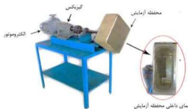
شکل ۶- دستگاه آزمون دوام ساخته شده بر اساس استاندارد ASAE S269/4.
